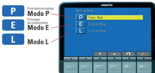
Puede seleccionar los modos de potencia o ahorro con solo presionar una vez el panel monitor, según las cargas de trabajo.
