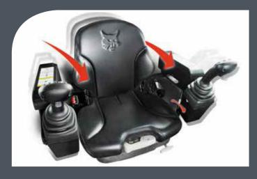
Posicionamiento flexible del joystick: Los soportes de los joysticks en nuestras máquinas equipadas con el sistema de controles seleccionables de joystick se deslizan hacia adelante y hacia atrás de forma independiente al asiento, permitiendo a cada operador ajustarlos de acuerdo con sus preferencias.
