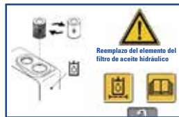
Mensaje de precaución de obstrucción del filtro de aceite hidráulico
