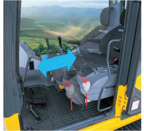
Capacidad de deslizamiento del asiento: 340 mm aumentado en 120 mm
