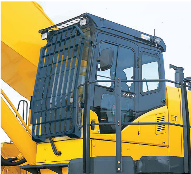
Protección delantera completa nivel 2 para la cabina (ISO 10262)
