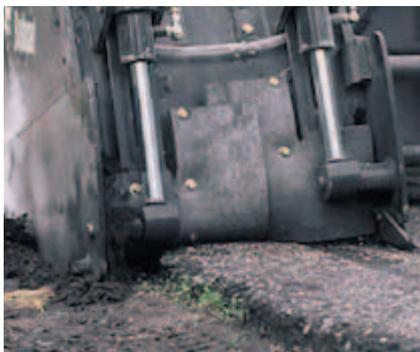
Las **almohadillas protectoras de los patines** son recambiables y permiten un control de profundidad consistente ya que atraviesan cualquier material que encuentren a su paso. Existe un conjunto de ruedas opcional para sustituir a los patines.
