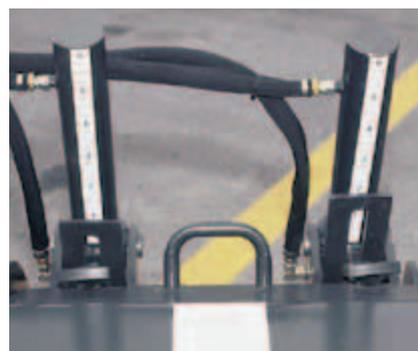
La **profundidad de los patines** se marca en un indicador de profundidad visible desde el asiento del operador.
