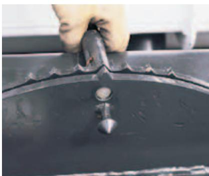
El **alojamiento de la fresadora** oscila  $\pm 15^\circ$  para cortar en ángulo o para igualar superficies irregulares. La máquina va equipada con un indicador con marcas cada  $5^\circ$  de oscilación. Si se desea, el indicador puede fijarse en una determinada posición.
