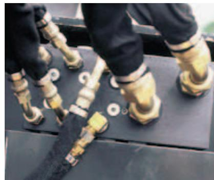
La fresadora de alto caudal utiliza una **válvula prioritaria** que desvía aceite a las funciones de profundidad sin provocar pérdidas de potencia momentáneas en el tambor de la fresadora. De esta manera, el operador puede realizar ajustes sobre la marcha.\*\*
