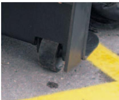
Las **ruedas de acero** montadas en el bastidor trasero proporcionan estabilidad a la fresadora cuando se inicia una operación de corte o cuando se realiza una operación de fresado.
