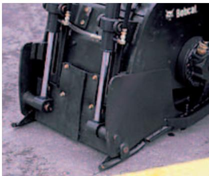
Los **cilindros dobles**, que se regulan independientemente, proporcionan control de profundidad para cada uno de los patines.\*\*
