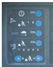
»Panel de control de resbalamiento de la zapata de la oruga
