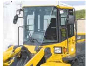
»El área de la cabina es la más amplia en su clase y entrega el máximo espacio para el operador. El asiento posee inclinación aumentada y ajuste de desplazamiento posterior mediante la introducción de una unidad de aire acondicionado con montaje frontal.
